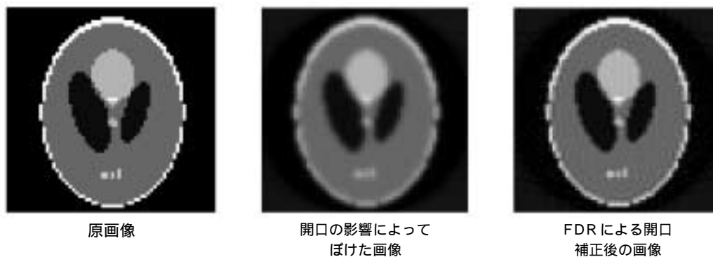
図6 再構成画像における開口によるボケとFDRを利用した補正
